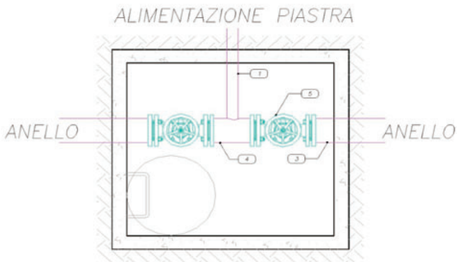
Figura 8 – Pozzetto acquedotto, Pianta.
